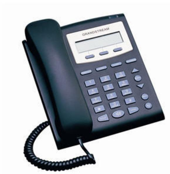
A configuração deste Telefone IP consiste em acessar o seu software de configuração através do seu navegador web (**browser**). Caso você não saiba o endereço IP do seu Telefone IP GXP280, é possível obtê-lo pelo visor do aparelho, teclando **MENU** em seguida com as setas direcionais selecione **Status** e clique em **Menu** novamente. O aparelho irá lhe mostrar no LCD o endereço de IP em que ele se encontra.
