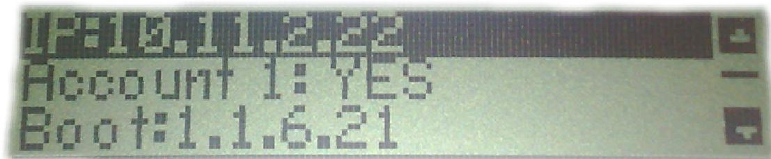
1. No caso do nosso exemplo, o nosso Telefone IP se encontra no IP 10.11.2.22 e para acessá-lo basta digitarmos o IP na barra de endereços do seu navegador de internet ex. (Google chrome). Certifique-se que este IP está liberado de qualquer proxy configurado no navegador;
